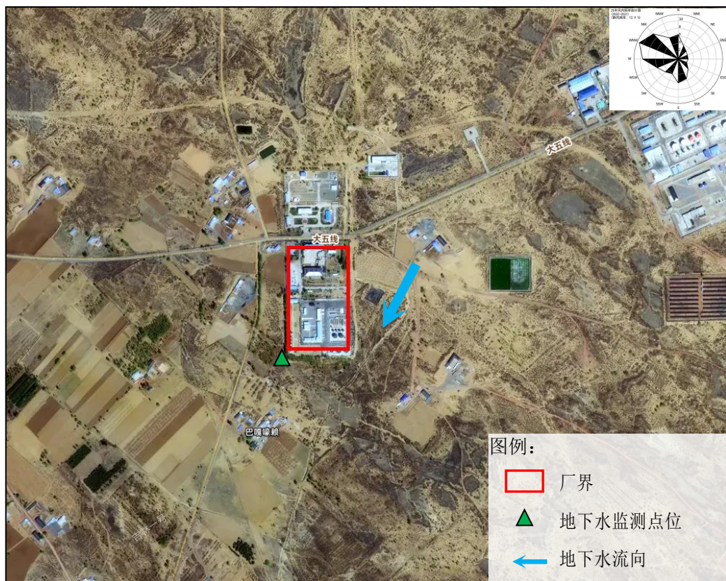
图 3-2 地下水水质监测布点示意图
