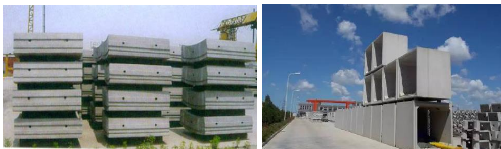
图 7-15 装配式隧道管片及管廊产品示意图
