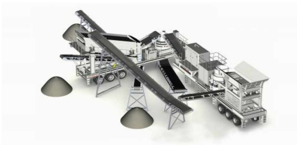
图 7-7 移动式建筑垃圾处理设备示意图
